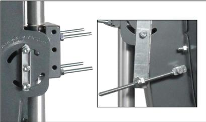
Auf dem Tragarm ist eine Elevationsskala eingepreßt, die das Voreinstellen des Neigungswinkels erleichtert. Durch Drehen an einer Mutter auf einer Gewindestange können Sie die Feineinstellung der Elevation vornehmen.
